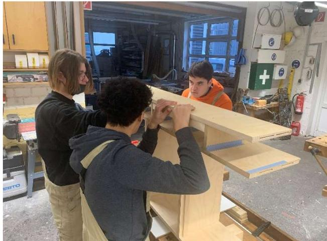
Mit dem Zusammenbau von Schrankkästen und Stollen war zwar schon bald die Struktur des Möbels zu erkennen, jedoch fehlten noch wesentliche Teile: Rückwände, Türen, Anschlagleisten, Einlegeböden und Schubkastenteile mussten zugeschnitten bzw. ausgehobelt werden. Anschließend folgten wieder Bohr- und Fräsarbeiten für Verbindungen und Einbau. Die Herstellung der zehn Schubkästen nahm mehr Zeit in Anspruch,
